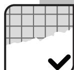
En présence de revêtements en carreaux céramique, traiter la surface en éliminant les joints et en lissant avec un primaire de lissage.
