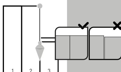
Die Innenseite des Gewebes in Abrollrichtung anbringen und mit dem Senkblei überprüfen. Im Fall von nicht perfekter Anbringung entfernen und erneut anbringen. Die Bahnen sauber ansetzen, leicht mit dem Kunststoffspachtel von der Mitte nach oben und unten andrücken, um eventuelle Luftblasen zu entfernen und eine perfekte Haftung zu gewährleisten. Eventuellen überschüssigen Kleber umgehend und mit einem Cutter Überschüsse entfernen.
