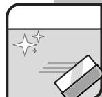
En cas d'application prévue sur un mur en béton, il faut vérifier l'absence de remontées capillaires. Si le béton est neuf, il faudra attendre sa maturation complète.
