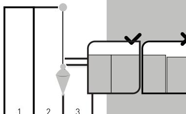
Приложите к стене внутреннюю поверхность ткани в направлении разметки рулона, проверьте вертикальность. Если укладка неправильная, снимите полотно и повторите действия. Совместите края ткани, чтобы не нарушился рисунок, и слегка прижмите шпателем от центра вверх и вниз для удаления воздушных пузырей и обеспечения отличного прилегания. Сразу удаляйте излишки kleя и обрежьте края ножом.
