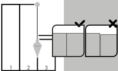
Aplique en la pared el lado interno del tejido en el sentido de desenrollamiento, verificando su aplomo. En caso de que no quede perfecta, retire el rollo de papel y vuélvalo a colocar. Acerque las telas asegurando la continuidad del dibujo y haga una ligera presión con la espátula de plástico, desde el centro hacia arriba y hacia abajo, eliminando las eventuales burbujas de aire y garantizando una adherencia perfecta. Quite de inmediato los eventuales restos de cola y corte con un cutter.
