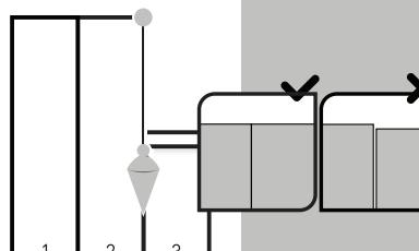
Applicare a parete il lato interno del tessuto nel senso di srotolamento, verificandone l'appiombatura. In caso di posa non perfetta, rimuovere il telo e riposizionarlo. Accostare i teli assicurandosi la continuità del disegno e pressare leggermente con spatola di plastica dal centro verso l'alto e verso il basso eliminando eventuali bolle d'aria, garantendo una perfetta aderenza. Rimuovere immediatamente eventuali eccedenze di colla e rifilare con taglierino. Lasciare asciugare.
