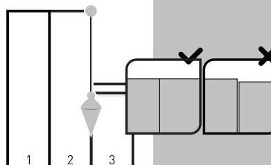
Die Innenseite des Gewebes in Abrollrichtung anbringen und mit dem Senklei überprüfen. Im Fall von nicht perfekter Anbringung entfernen und erneut anbringen. Die Bahnen sauber ansetzen, leicht mit dem Kunststoffspachtel von der Mitte nach oben und unten andrücken, um eventuelle Luftblasen zu entfernen und eine perfekte Haftung zu gewährleisten. Eventuellen überschüssigen Kleber umgehend und mit einem Cutter Überschüsse entfernen.
