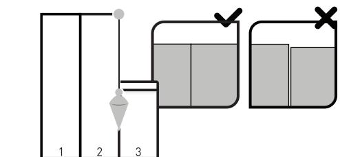
Die Innenseite des Gewebes in Abrollrichtung anbringen und mit dem Senkblei überprüfen. Im Fall von nicht perfekter Anbringung entfernen und erneut anbringen. Die Bahnen sauber ansetzen, leicht mit dem Kunststoffspachtel von der Mitte nach oben und unten andrücken, um eventuelle Luftblasen zu entfernen und eine perfekte Haftung zu gewährleisten. Eventuellen überschüssigen Kleber umgehend und mit einem Cutter Überschüsse entfernen. Trocknen lassen.
