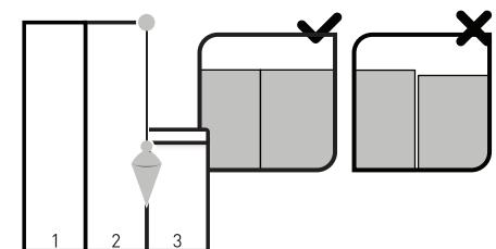
Aplique en la pared el lado interno del tejido en el sentido de desenrollamiento, verificando su aplomo. En caso de que no quede perfecta, retire el rollo de papel y vuélvalo a colocar. Acerque las telas asegurando la continuidad del dibujo y haga una ligera presión con la espátula de plástico, desde el centro hacia arriba y hacia abajo, eliminando las eventuales burbujas de aire y garantizando una adherencia perfecta. Quite de inmediato los eventuales restos de cola y corte con un cutter.
